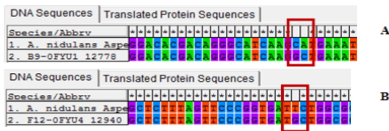
Figura 8. Comprobación de la mutagénesis dirigida. El cuadro rojo enmarca el triplete donde se produjo el cambio de nucleótido. (A) Triplete codificante para His1033 → Ala y (B) triplete codificante para Ser1142 → Ala.
